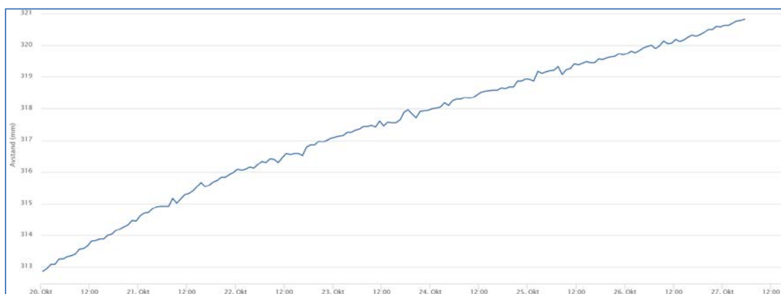
Figur 2. Forskyvning siste uke, målt med ekstensometer 8.
